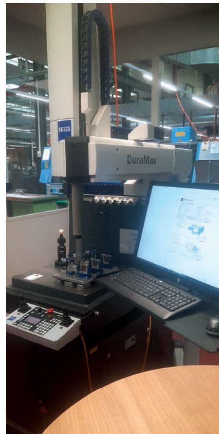
Une machine de mesure de haute précision doit être installée dans un endroit propre, exempt de poussières et de vapeurs d'huile, climatisé ou au moins dont la température est régulée, surtout pendant les grandes chaleurs.
